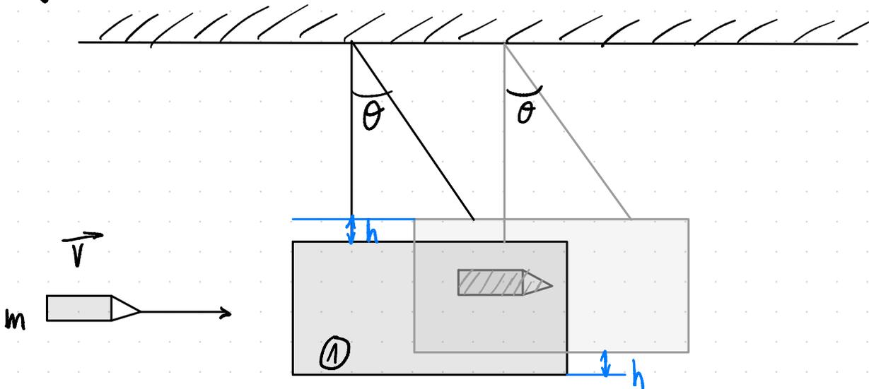
Zuerst wird der Impulserhaltungssatz für das Projektil und den Holzblock angewandt.
