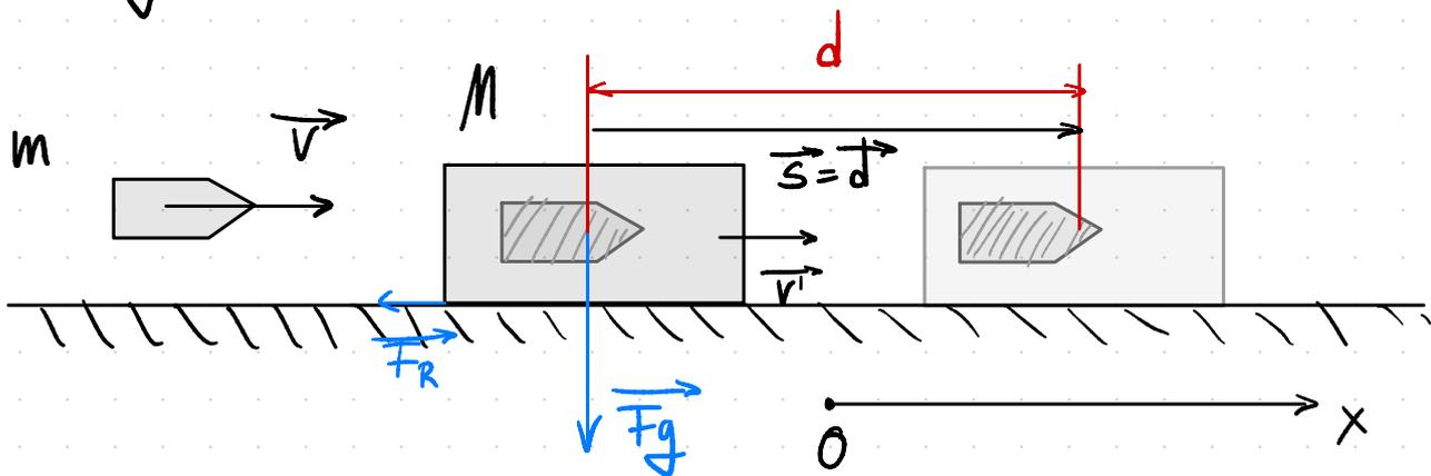
a. Zuerst wird der Energiesatz für den gerade vom Geschoss getroffen und rutschenden Holzblock angewandt.
